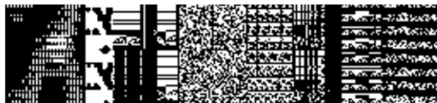
Obr. 2.1: Grafické znázornenie binárnych dát alebo pamäte programu (bit s hodnotou 0 ako čierna bodka, bit s hodnotou 1 ako biela).
